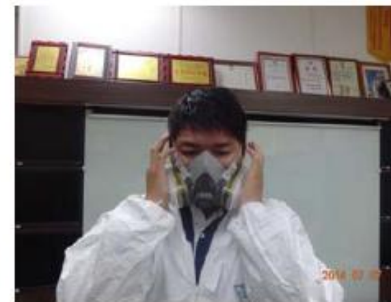
5.進行氣密測試- 負壓測試
