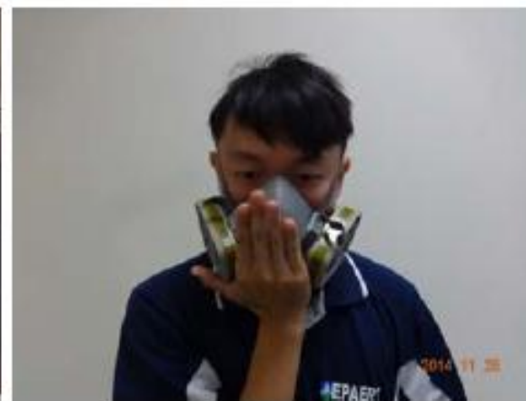
5.進行氣密測試- 正壓測試
