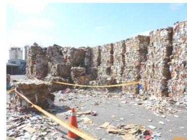
回收紙堆疊過高沒有護網等防倒崩塌設備
